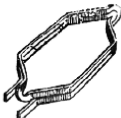
Фиг. 84. Двухоборотная секция с ординарной головкой.
