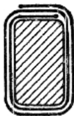
Фиг. 29. Изолировка с перекрытием на 2\frac{1}{4}
