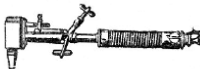
Фиг. 4. Паяльник, нагреваемый бензиновой горелкой.
