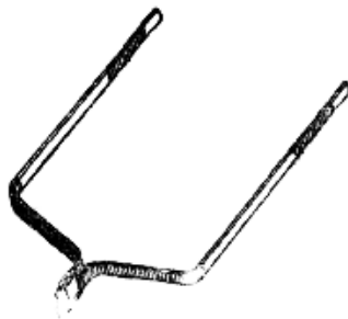
Фиг. 32. Стержни роторной обмотки.
