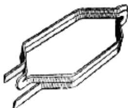
Фиг. 85. Двухоборотная секция с двойной головкой.
